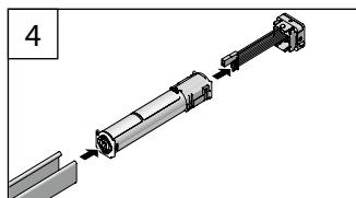
Seitendeckel und Motor seitlich aus dem Oberprofil ziehen.
