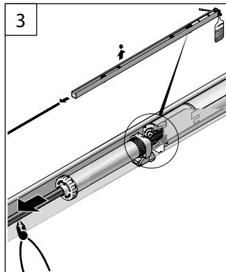
Welle seitlich aus dem Motorkopf ziehen.
